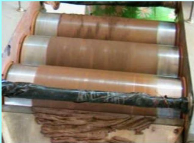
Полимеризация композиции при 100-150°C + SHF of 2.4 GHz
