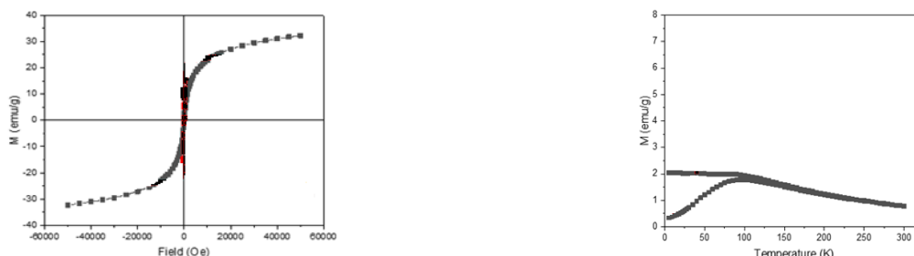
Рисунок 1 – Зависимость намагниченности от внешнего магнитного поля, измеренная при 300 К и температурные зависимости намагниченности наночастиц Ag/Fe 3 O 4 .
